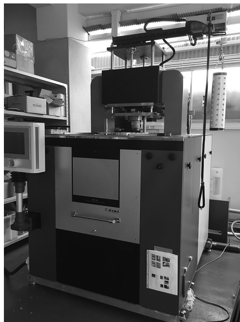
同社製の圧力酵素分解装置。600メガパスカル（マリアナ海溝の約6倍の圧力）もの超高圧がかけられる
